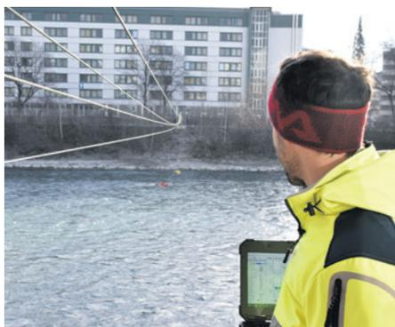
Schritt für Schritt werden Wassertiefe und Fließgeschwindigkeit über die gesamte Breite des Inns gemessen.
