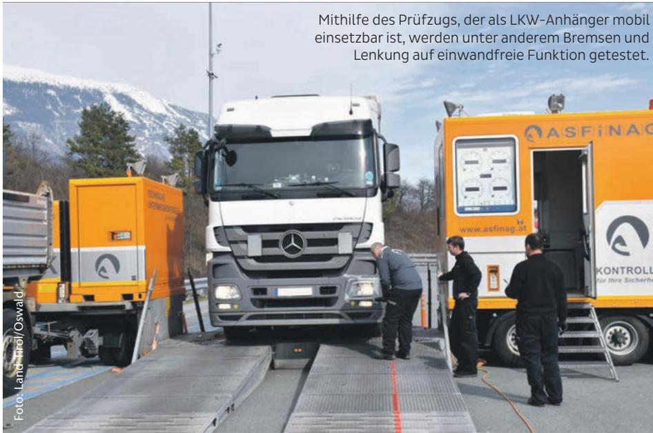
Mithilfe des Prüfzugs, der als LKW-Anhänger mobil einsetzbar ist, werden unter anderem Bremsen und Lenkung auf einwandfreie Funktion getestet.
